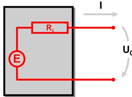
Ein Zweipol wird durch die „ideale“ Ursprungung  $E$  und den Innenwiderstand  $R_i$  beschrieben!
