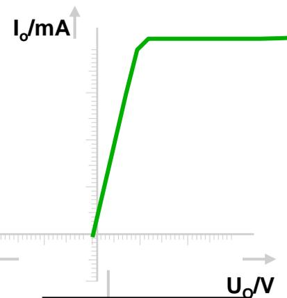
Ausgangskennlinie bei „L“ am Ausgang
