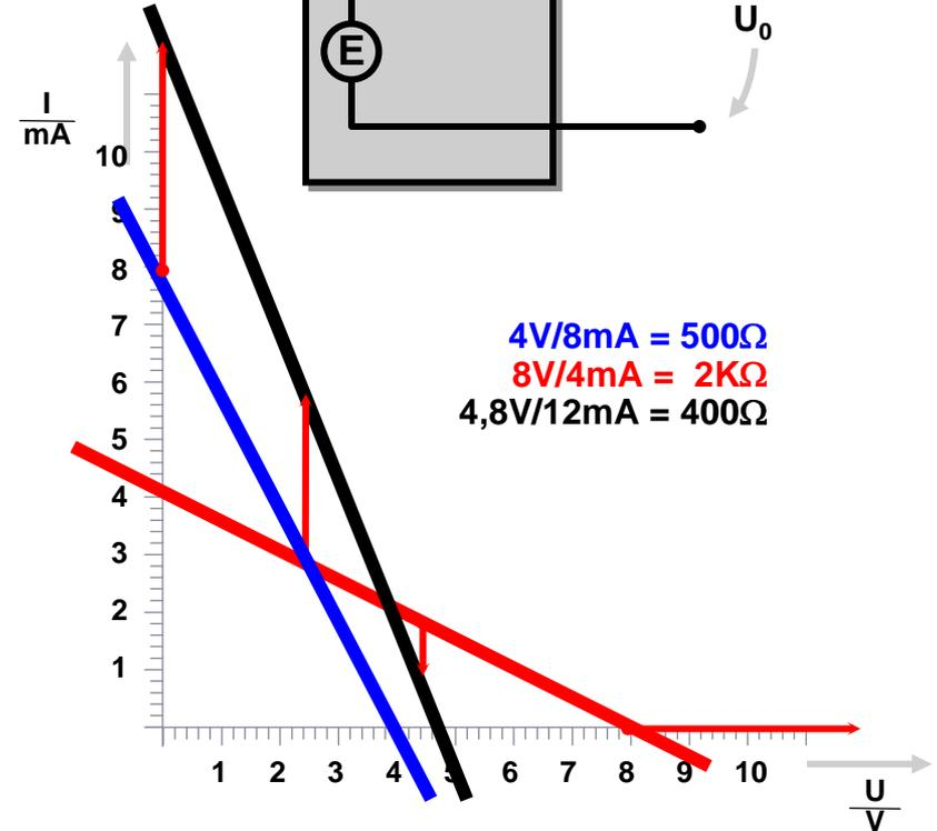
**Man addiert die Ströme bei gleicher Spannung!**
