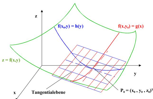
Ebenengleichung für die Tangentialebene an  $f(x, y)$  im im Punkt  $P_0 = (x_0, y_0, z_0)^T$
