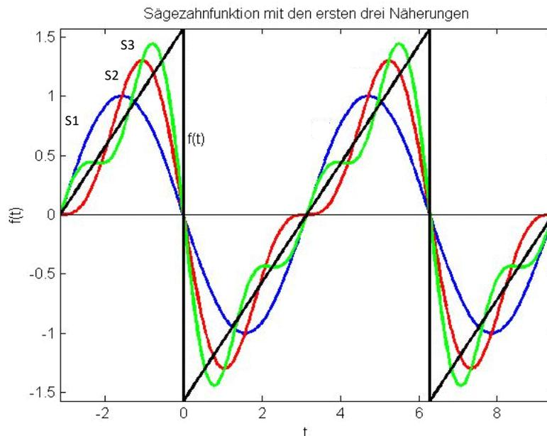
In diesem Beispiel war die zu entwickelnde Funktion  $f(t)$  eine einheitliche lineare Funktion im Intervall  $[0; T]$ . Damit waren die Integrale für  $c_0$  und  $c_k$  genau über dieses Intervall zu bilden und mussten nicht geteilt werden, weil sich die Beschreibung der Funktion  $f(t)$  im Intervall ändert. Im nächsten Beispiel ist aber genau das der Fall:
