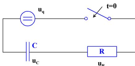
$$RC \frac{du_C}{dt} + u_C = u_q, \text{ Gesucht ist die Spannung } u_C \text{ am Kondensator.}$$
