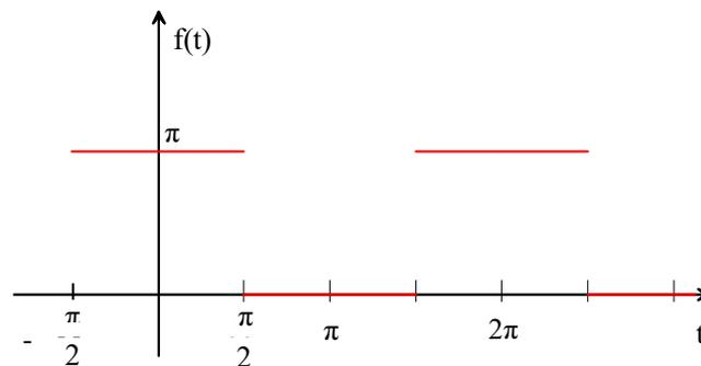
Im Integrationsintervall  $[0; T] = [0; 2\pi]$  ändert sich die Funktionsbeschreibung sogar zweimal, bei  $t = \frac{\pi}{2}$  und  $t = \frac{3\pi}{2}$ . D.h. an diesen Stellen muss das Integral über  $[0; 2\pi]$  aufgeschnitten und in die Summe von 3 Teilintegralen zerlegt werden. Das ist aufwendig und kann mit den beiden folgenden Bemerkungen abgemildert werden.
