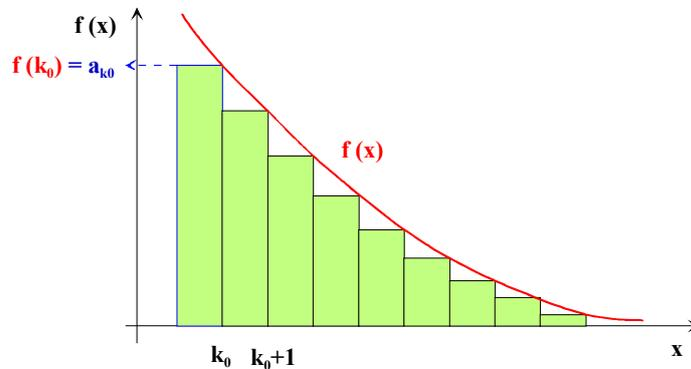
Die grüne Fläche repräsentiert die Reihe  $\sum_{k=k_0}^{\infty} a_k$ . Sie kann offensichtlich durch die Fläche  $A$  unter der Kurve  $f(x)$   $A = \int_{k_0}^{\infty} f(x) dx$  nach oben abgeschätzt werden. Existiert das Integral, muss folglich auch die Summe der Reihe einen endlichen Wert liefern.
